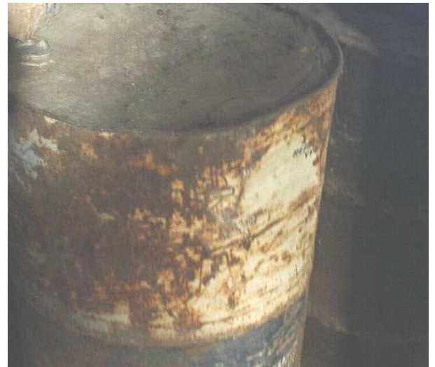
Tambores corroídos que contienen DDT acopiados directamente sobre el suelo.
